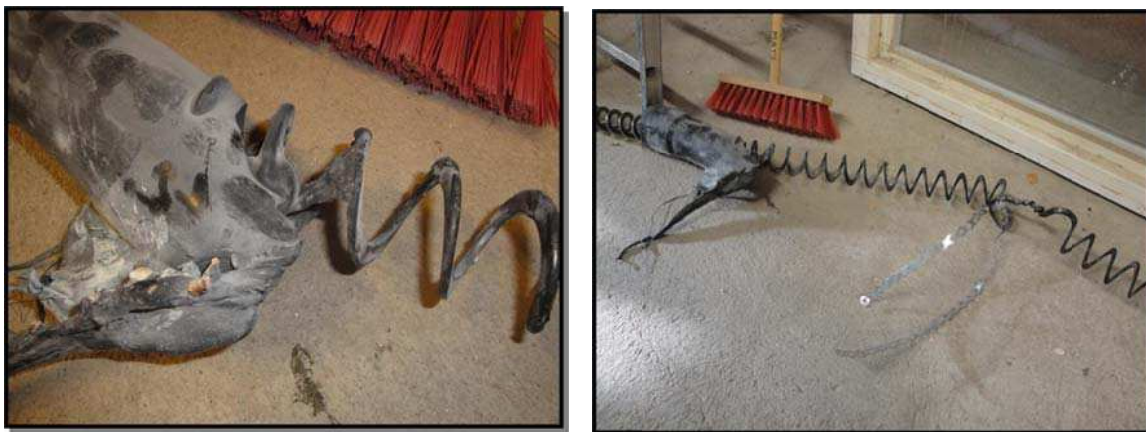
Bild 5 Rester av nedsmält transportrör och söndervriden pelletskruv. Felet orsakade brand som kunde släckas innan större skada uppstod. (Foto U. Svedberg).
